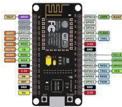
**Fig 4.** NodeMcu ESP8266
