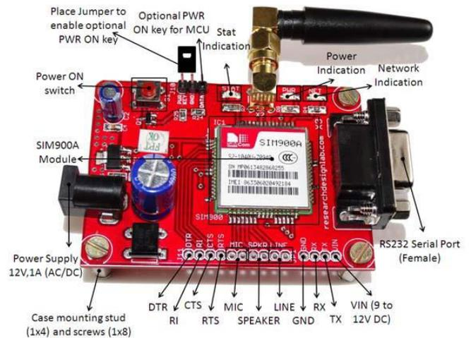
**Fig 11.** GSM module
