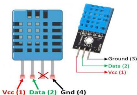
Fig 5. DHT-11 Sensor
